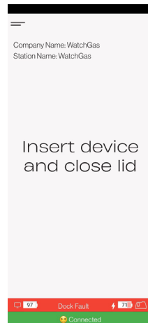
Pulsa "Dock Fault" (Fallo de la estación) para eliminar el error
