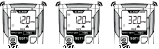
Basso intervallo di allarmi acustici e visivi Allarme TWA e STEL - Intervallo intermedio di allarmi acustici e visivi Allarme elevato - Intervallo rapido di allarmi acustici e visivi
